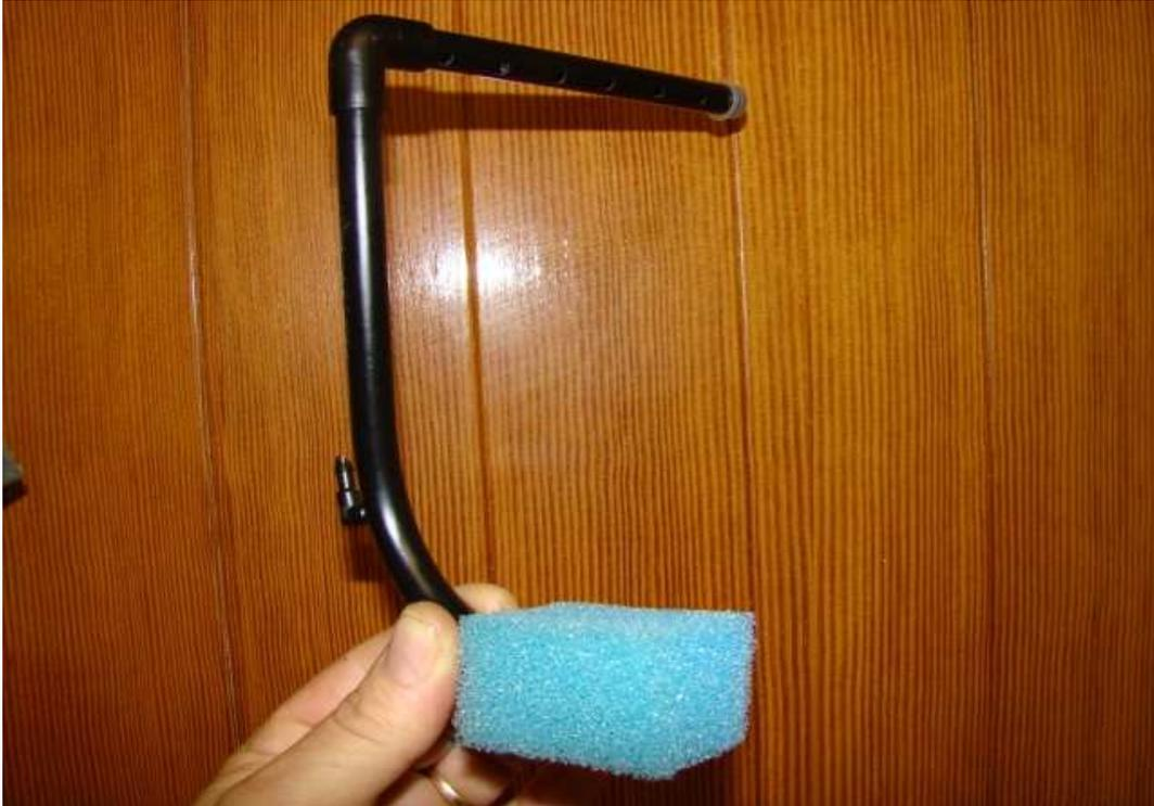
Detalle de la tubería empleada, el codo de conexión entre la flauta y el resto de tubería es comprado, si fuera de construcción casera ocuparía mucho espacio en su desarrollo .
