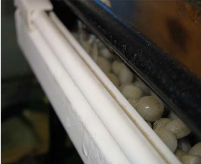
Detalle del filtro cargado con SIPORAX
